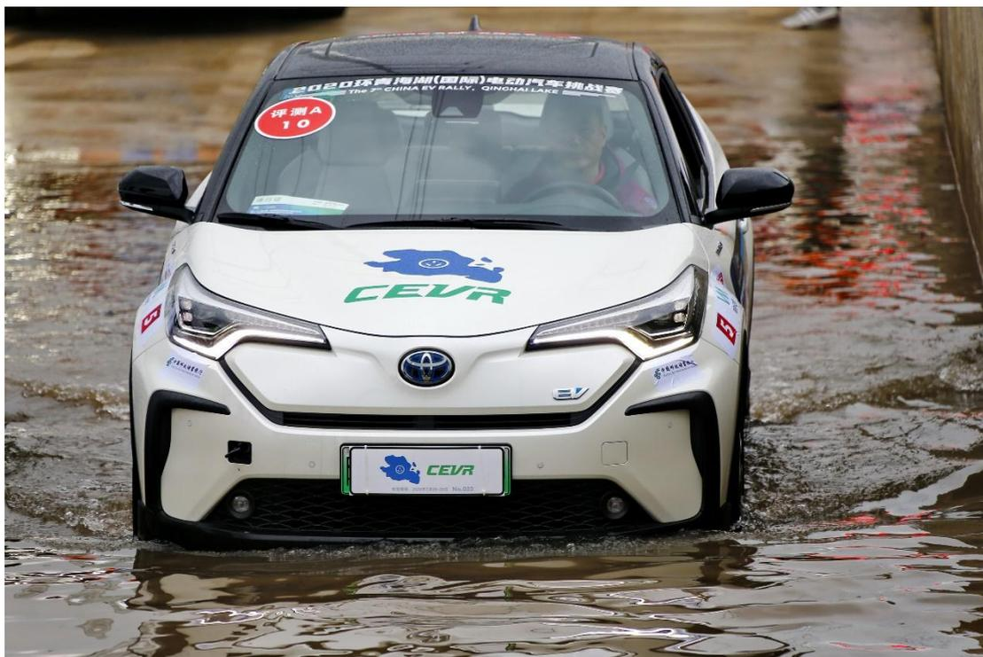
续航能力测评环节，是在一般道路上以满电状态下所能行驶的最大里程为标准，测试各参赛车辆真实的续航能力。丰田 C-HR EV/奕泽 E 进擎在 NEDC 工况下续航为 400 公里，本次实际道路测评成绩为 468 公里，是一款可以让消费者摆脱里程焦虑的车型。
